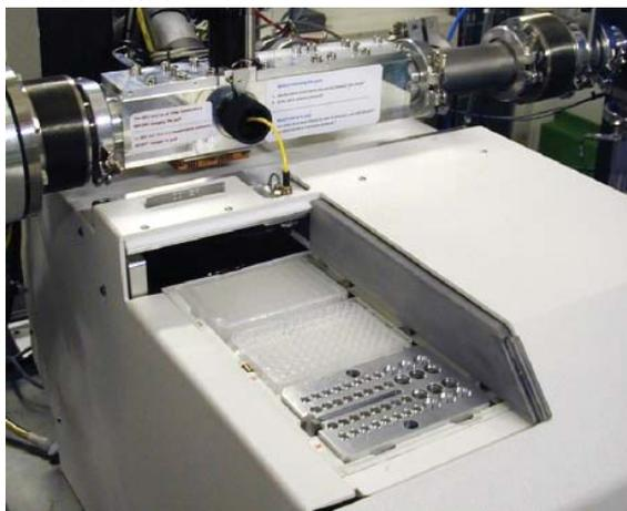
Gros plan du changeur d'échantillon sur ID14-3 avec le compartiment de stockage des échantillons ouvert.
